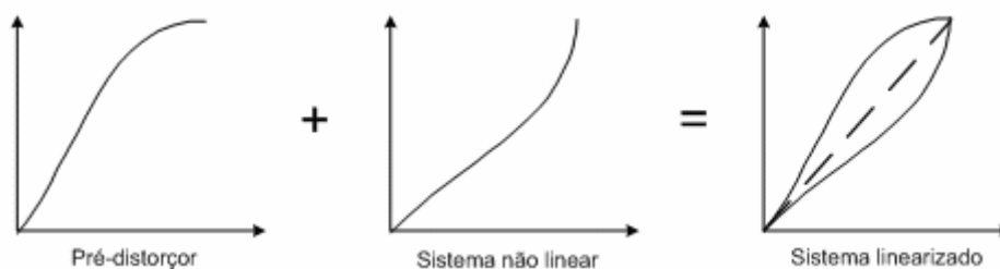
Fig. 24- Resposta de um sistema de linearização por pré-distorção
