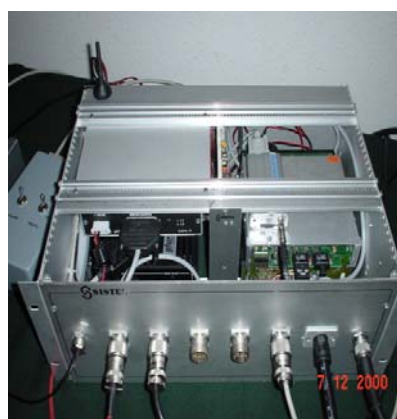
Figura 70 – Posto Móvel com GSM – Pormenor do Modem GSM
