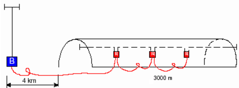
Figura 118 – Cobertura em túneis com uma grande extensão
