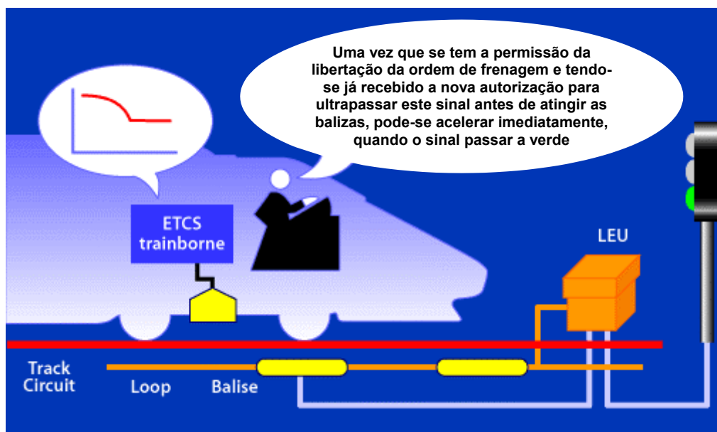
Figura 158 – Nível 1 com EUROBALISE com permissão da libertação da ordem de frenagem
