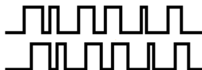
Figura 31 – Comparação entre os códigos do satélite e do receptor (I)
