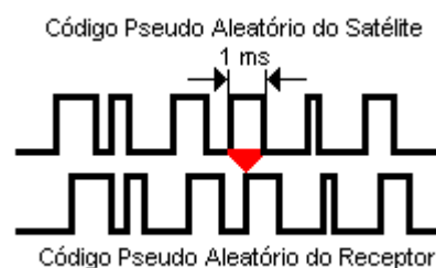
Figura 32 – Comparação entre os códigos do satélite e do receptor (I)
