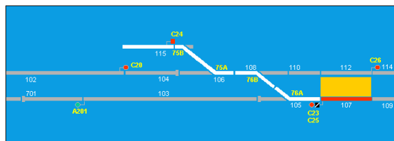
a) Itinerário realizado de uma linha geral da estação para uma linha desviada.
