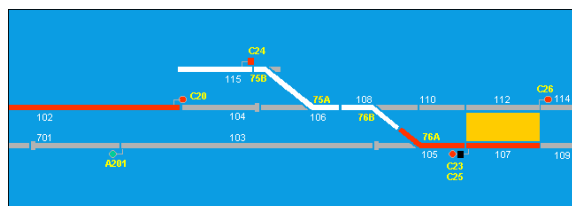
c) O comboio inicia o deslocamento para a linha desviada.
