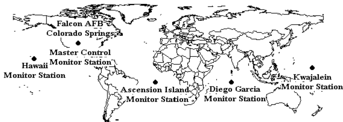
Figura 18 – Estações de Monitorização do GPS
