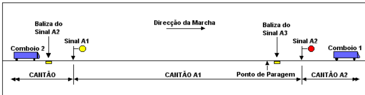
Figura 145 – Localização das Balizas ao longo da Via
