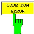
Der Softkey *CODE DOM ERROR* wählt die Darstellung der Code-Fehlerleistung (CDEP) über die Codenummern der Code-Klasse 9 aus. Die Fehlerleistung wird auf die Gesamtleistung des selektierten Slots bezogen.
