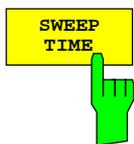
Der Softkey *SWEEP TIME* aktiviert die Eingabe der Sweepzeit. Mit dem RMS-Detektor führt eine längere Sweepzeit zu stabileren Meßergebnissen.
