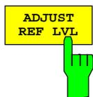
Der Softkey *ADJUST REF LVL* paßt den Referenzpegel des FSU an die gemessene Gesamtleistung des Signals an.
