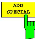
Der Softkey *ADD SPECIAL* ermöglicht das Hinzufügen von Sonderkanälen zur Kanaltabelle. Für eine installierte FS-K72 können gegenwärtig die Sonderkanäle PICH und SCCPCH, die in den 3GPP-Test-Modellen enthalten sind, zu den Kanaltabellen hinzugefügt werden. Der Eintrag dieser Sonderkanäle ist lediglich einmal pro Kanaltabelle möglich.
