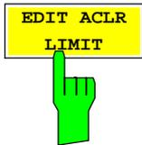
*EDIT ACLR LIMITS* öffnet eine Tabelle mit den Grenzwerten für die ACLR-Messung. Durch Betätigen des Softkeys *ADJUST SETTINGS*. Werden die vom Standart abhängigen Default Werte eingetragen.
