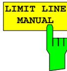
Der Softkey *LIMIT LINE MANUAL* gibt dem Benutzer die Möglichkeit, die Grenzwertlinie von Hand auszuwählen. Wird dieser Softkey angewählt, wird die Kanalleistungsmessung nicht für die Auswahl der Grenzwertlinie, sondern nur für die Bestimmung deren relativer Anteile genutzt. Die Leistung bei den verschiedenen Frequenz-Offsets wird gegen die vom Benutzer angegebene Grenzwertlinie verglichen.
