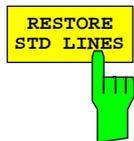
Der Softkey *RESTORE STD LINES* überführt die im Standard definierten Limit Lines wieder in den Zustand, in dem sie bei Auslieferung des Gerätes waren. Dadurch wird eine versehentliche Überschreibung der Standard-Lines unschädlich gemacht.
