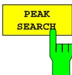
Der Softkey *PEAK SEARCH* aktiviert eine Einzelmessung der Spektrum Emission Mask. Nach Abschluß der Messung wird die Limit-Maske – verringert um ein globales Margin – gegen den Trace verglichen. Die Positionen, an denen der Trace die Maske verletzt, werden mit Kreuzen markiert. Jeder Meßpunkt wird in eine Peak-Liste aufgenommen, die geöffnet oder im ASCII-Format gespeichert werden kann. Die Liste kann über IEC-Bus ausgelesen werden
