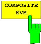
Der Softkey *COMPOSITE EVM* wählt die Darstellung der Error Vector Magnitude (EVM) über das Gesamtsignal (Modulation Accuracy) gemäß der 3GPP-Spezifikation.
