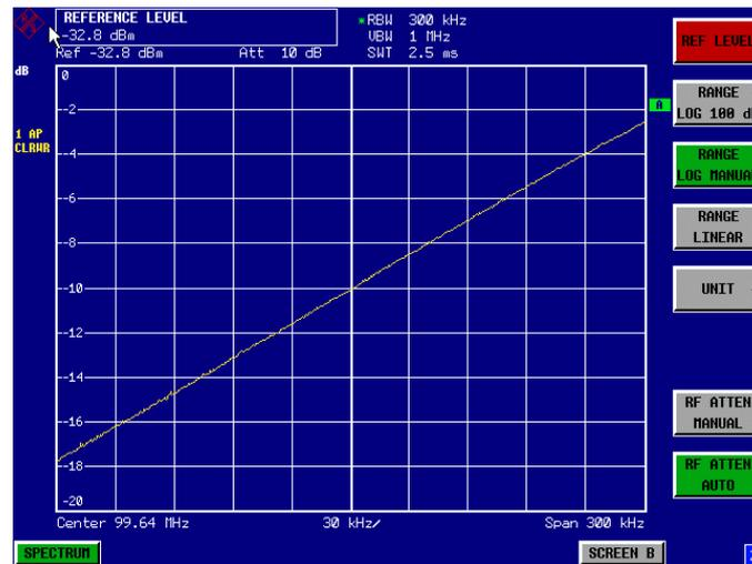
Bild 2-32 Darstellung der Filterflanke des  $300\text{-kHz}$ -Filters als FM-Diskriminatorkennlinie.
