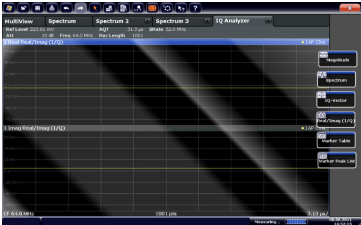
그림 4-8: I/Q 분석에 대한 Real/Imag 다이어그램 삽입하기
