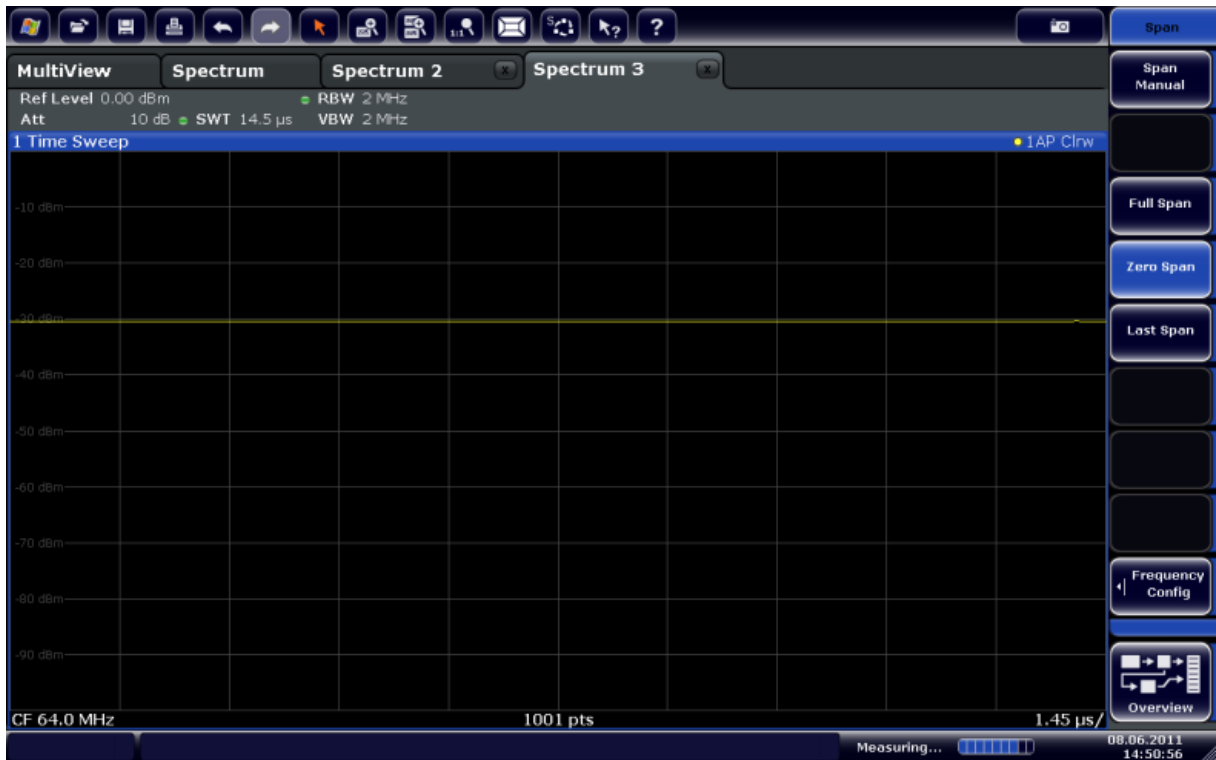
그림 4-7: 교정 신호의 Time Domain 표시
