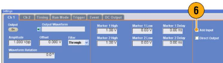
7. Когда прибор работает в режиме с пропуском, можно выбрать выходные данные сигнала, используя поле Output Waveform (Форма выходного сигнала). Щелкните список форм сигналов, чтобы вывести на экран диалоговое окно Waveform List (Список форм сигналов).
