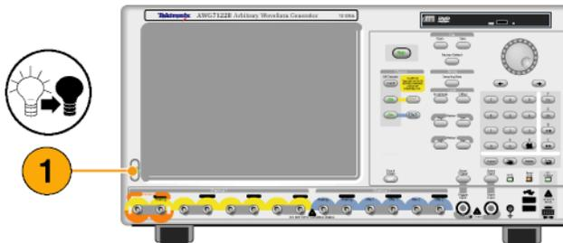
2. Чтобы полностью отключить питание прибора, выполните процедуру завершения работы, описанную выше, и отсоедините шнур питания от прибора.
