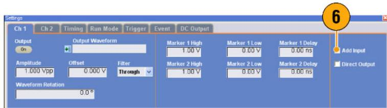
7. 当仪器处于非序列模式时，可使用 Output Waveform（输出波形）字段选择输出波形数据。单击波形列表图标显示 Waveform List（波形列表）对话框。
