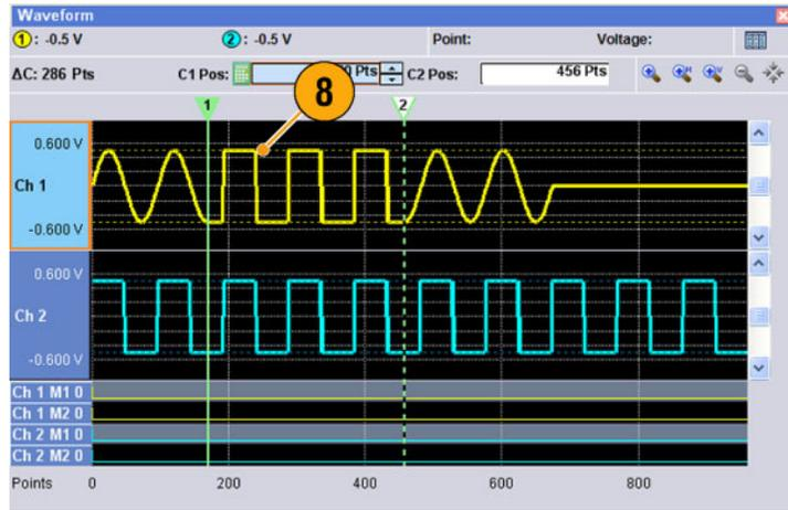
9. 这是一个**粘贴-插入**示例。Ch 2 波形的指定范围被插入到 Ch 1 波形上。Ch 1 波形长度发生改变。
