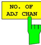
Der Softkey *NO. OF ADJ CHAN* aktiviert die Eingabe der Anzahl  $\pm n$  der Nachbarkanäle, die für die Nachbarkanalleistungsmessung berücksichtigt werden.
