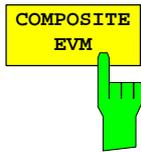
Der Softkey *COMPOSITE EVM* wählt die Darstellung der Error Vector Magnitude (EVM) über das Gesamtsignal (Modulation Accuracy) gemäß der 3GPP-Spezifikation. Der Softkey ist nur für die Analyse eines Frames des 3GPP-Signals verfügbar.
