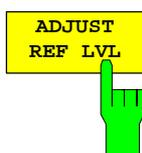
Der Softkey *ADJUST REF LVL* paßt den Referenzpegel des Spektrumanalysators an die gemessene Kanalleistung an. Damit wird sichergestellt, daß die Einstellungen der HF-Dämpfung und des Referenzpegels optimal an den Signalpegel angepaßt werden, ohne daß der Spektrumanalysator übersteuert wird oder die Dynamik durch zu geringen Signal-Rauschabstand eingeschränkt wird.
