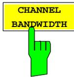
Der Softkey *CHANNEL BANDWIDTH* aktiviert die Eingabe der Kanalbandbreite für den Übertragungskanal.
