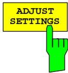
Der Softkey *ADJUST SETTINGS* optimiert die Pegelinstellungen des Spektrumanalysators entsprechend der gemessenen Spitzenleistung zur Erzielung der maximalen Empfindlichkeit des Geräts.
