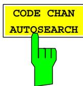
Der Softkey *CODE CHAN AUTOSEARCH* ermöglicht Messungen der Code-Domain-Power im automatischen Suchmodus. In diesem Modus wird der gesamte Code-Raum (alle zulässigen Symbolraten und Kanalnummern) nach aktiven Kanälen durchsucht. Die Kanalsuche stützt sich dabei auf die Leistungsverhältnisse belegter im Vergleich zu unbelegten Kanälen; außerdem wird von den in der Norm definierten Zusammenhängen beim Belegen von Kanälen ausgegangen.
