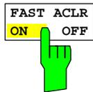
Der Softkey *FAST ACLR* schaltet zwischen der Messung nach der IBW-Methode (*FAST ACLR OFF*) und der Messung im Zeitbereich (*FAST ACLR ON*) um.
