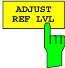
Der Softkey *ADJUST REF LVL* paßt den Referenzpegel des Spektrumanalysators an die gemessene Gesamtleistung des Signals an.
