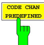
Der Softkey *CODE CHAN PREDEFINED* überführt die CDP-Analyse in den Meßmodus unter Zuhilfenahme vordefinierter Kanaltabellen. In diesem Modus wird keine Suche nach aktiven Kanälen im Code-Raum durchgeführt, sondern es werden die Kanäle einer vor der Messung definierten Kanaltabelle als aktiv vorausgesetzt. Für diese Kanäle werden die Code-Domain-Power bestimmt und sämtliche weiteren Auswertungen durchgeführt.
