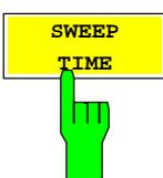
Der Softkey *SWEEP TIME* aktiviert die Eingabe der Sweepzeit. Mit dem RMS-Detektor führt eine längere Sweepzeit zu stabileren Meßergebnissen. Diese Einstellung ist identisch zur Einstellung *SWEEP TIME MANUAL* im Menü *BW*.
