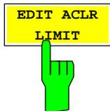
*EDIT ACLR LIMITS* öffnet eine Tabelle mit den Grenzwerten für die ACLR-Messung. Durch Betätigen des Softkeys *ADJUST SETTINGS*. Werden die vom Standart abhängigen Default Werte eingetragen.
