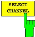
Der Softkey *SELECT CHANNEL* aktiviert die Auswahl eines Kanals für die Darstellungen *CDP PWR RELATIVE / ABSOLUTE*, *POWER VS SLOT*, *SYMBOL CONST*, *SYMBOL EVM*.
