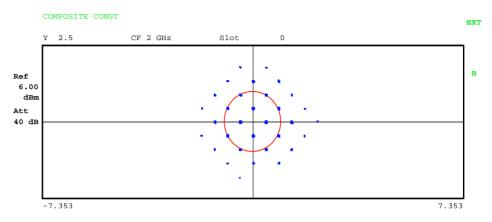
Bild 5-22 Composite Constellation Diagram
