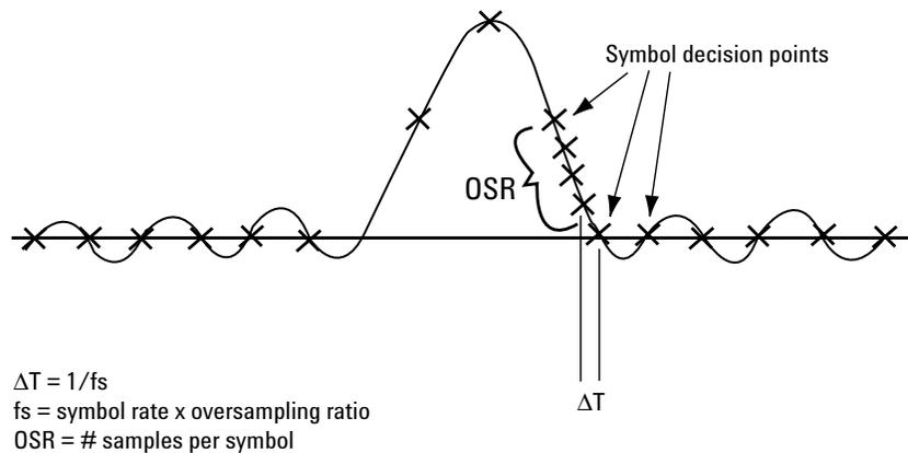
Figure 23. FIR filter parameters
